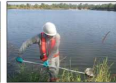
ภาพที่ 3.19 การตรวจวัดคุณภาพน้ำ บ่อพักตะกอนจากน้ำเหนือ (บ่อ 2)
